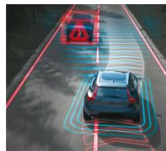
当您偏离车道线、驶入对向来车道，系统将警示提醒，并微调转向以驶回正常车道。系统通过自动的方向盘转向辅助，可降低与对向来车发生碰撞事故的风险。
