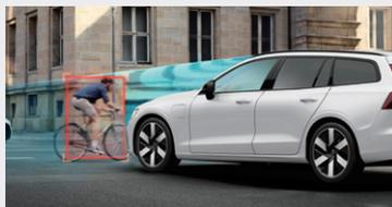
ミリ波レーダーとカメラを使用し、他の車両や歩行者、サイクリスト、大型動物と衝突の危険がある場合、警告やブレーキを作動させ、衝突の回避または被害軽減を支援します。また、交差点右折時の対向車の動きを監視し、必要に応じてブレーキを作動させるインターセクションサポート（右折時対向車検知機能）や、対向車線から進入してきた車両との衝突被害を軽減する対向車対応機能も備わっています。
