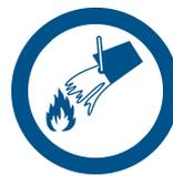
Verwenden Sie immer große Mengen Wasser zum Kühlen der Batterie, wenn die Traktionsbatterie in Brand gerät oder sich entlüftet oder einen Geruch abgibt. Verwenden Sie reines
