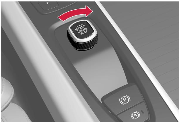
Drehen Sie den Startschalter im Uhrzeigersinn und lassen Sie ihn wieder los, um das Fahrzeug auszuschalten. Der Schalter kehrt automatisch in seine Ausgangsstellung zurück.
