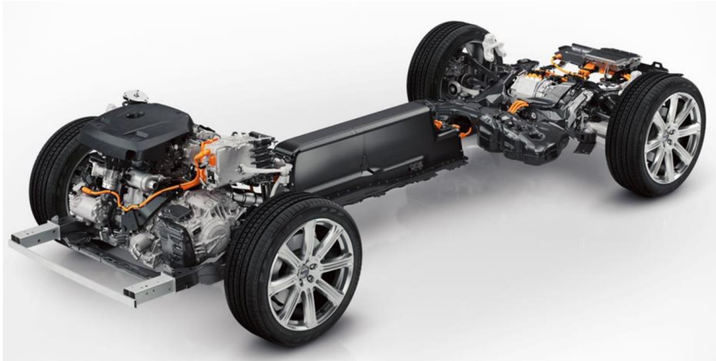
Naranja: líneas de alta tensión
