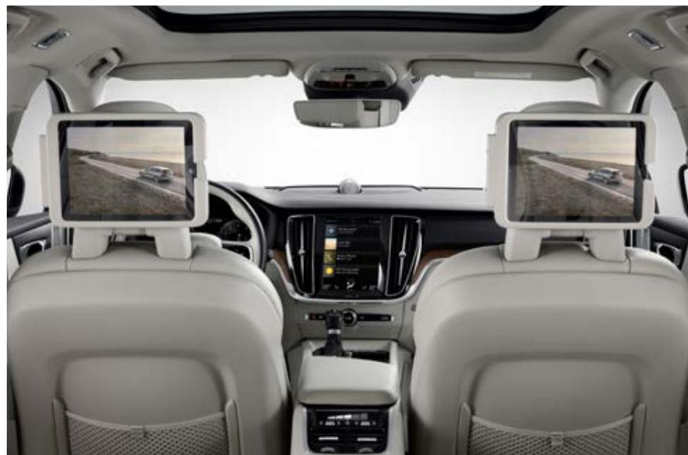
**A00462** - Supporto per iPad con sistema di ricarica del dispositivo
