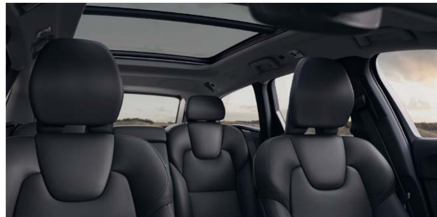
Tetto apribile in cristallo laminato a comando elettrico
