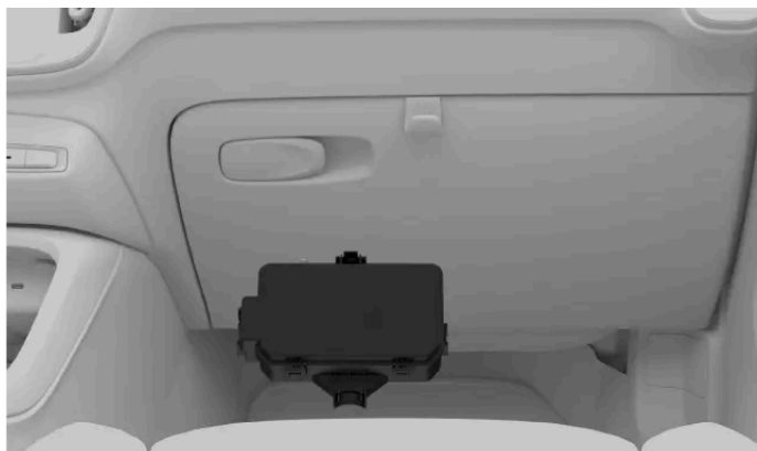
Ubicación de la caja de fusibles
