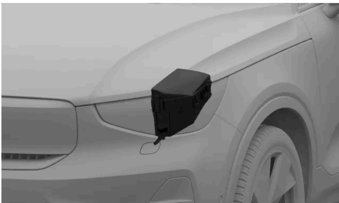
Ubicación de la caja de fusibles
