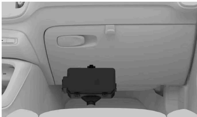
Ubicación de la caja de fusibles
