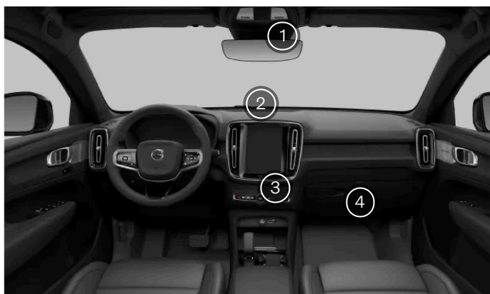
Los sensores de climatización interiores
