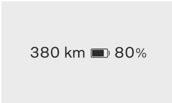
La autonomía depende sobre todo del nivel de batería del automóvil y los hábitos de conducción, pero las condiciones externas también pueden influir. El nivel de batería y la autonomía prevista aparecen en la zona de información del conductor. La autonomía prevista indica hasta dónde puede conducir con el nivel de batería actual. Se calcula teniendo en cuenta su patrón de conducción, actual e histórico, y las condiciones de conducción en tiempo real.
