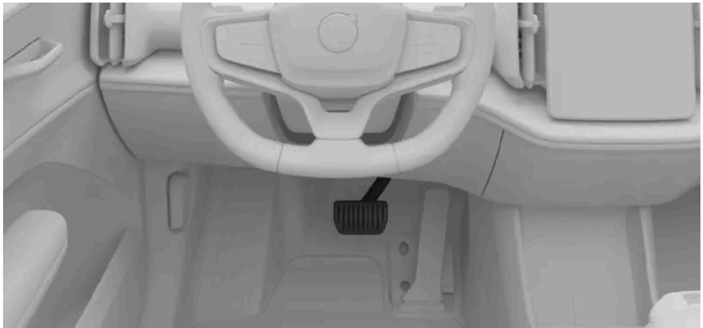
El freno de servicio acciona el frenado regenerativo o los frenos de fricción, dependiendo de cómo pisa el pedal. Un frenado suave activa el frenado regenerativo, mientras que un frenado más intenso activa los frenos de fricción.
