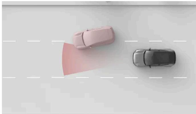
La zona de detección del radar delantero tiene una anchura limitada. Si otro vehículo se le echa encima, la detección puede producirse relativamente tarde y su automóvil respondería de forma brusca.
