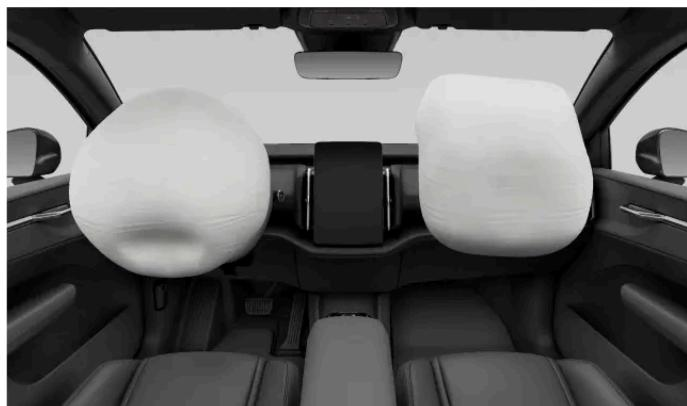
El airbag del lado del conductor está dentro del volante.
