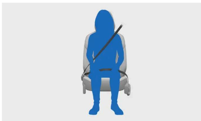
El cinturón de seguridad se bloquea y actúa como sistema de seguridad en determinadas condiciones. Por ejemplo, una tensión brusca y forzada en el cinturón, en caso de conducción agresiva del automóvil o si el automóvil está en una pendiente pronunciada.
