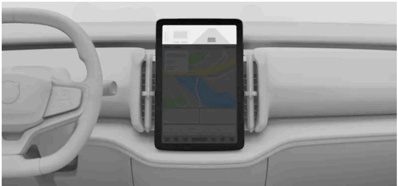
La zona de información del conductor no es sensible al tacto, por lo que no puede interactuar con ella a través de la superficie de la pantalla. Puede interactuar con la zona de información del conductor mediante los botones del volante.
