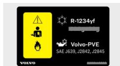
La etiqueta con información sobre los líquidos del sistema de climatización se encuentra debajo del capó, en la parte derecha del automóvil.
