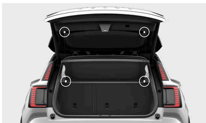
Hay dos puntos de fijación en la bandeja trasera y dos en la compuerta del maletero. Cuando la bandeja trasera está montada, unos cordones conectan la bandeja trasera con la compuerta del maletero.
