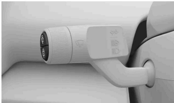
Botones del lavaparabrisas en la palanca izquierda del volante.
