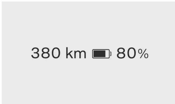
El indicador de la batería aparece en todo momento en la zona de información del conductor. El color del ícono de la batería cambia según el nivel de carga restante en la batería.
