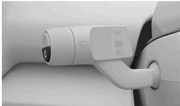
Puede controlar el limpiaparabrisas trasero utilizando el botón inferior en la palanca izquierda del volante.
