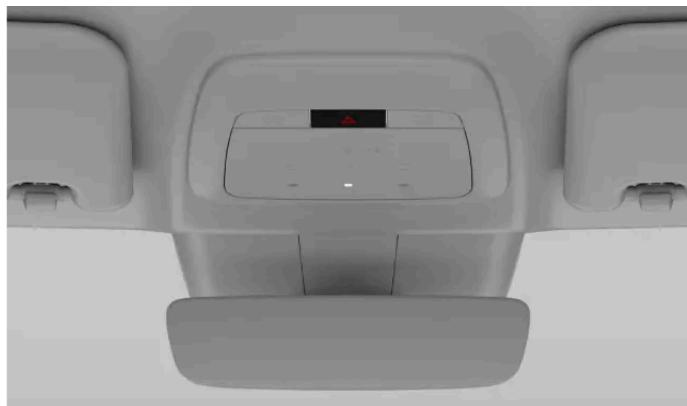
Posición del botón de las luces de emergencia en la consola del techo
