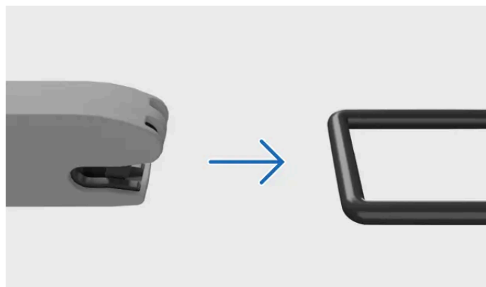
Conexión a punto de anclaje ISOFIX
