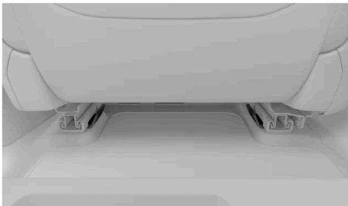
Los puntos de anclaje inferiores para los asientos traseros se encuentran en la parte trasera de las guías del piso de los asientos de delante.
