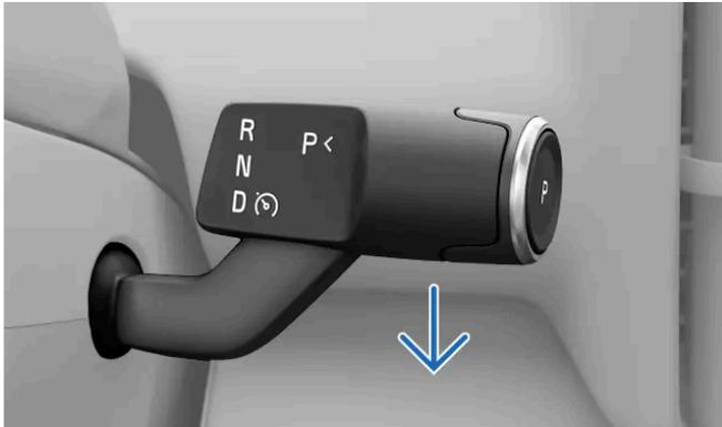
Baje la palanca derecha del volante hasta abajo.
