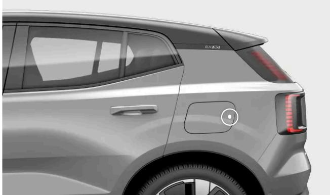
**3** Retire las tapas de protección del puerto de carga y el conector del cable.
