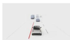
Las intervenciones de la asistencia para el mantenimiento en el carril se indican a través de una línea sólida de color rojo.
