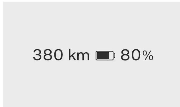
El indicador de la batería aparece en todo momento en la zona de información del conductor. El color del símbolo de la batería cambia según el nivel de carga restante en la batería.
