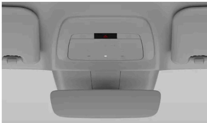
Posición del botón de las luces de emergencia en la consola del techo
