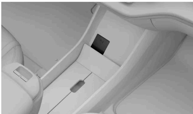
Posición del lector de tarjeta, utilizado para arrancar el automóvil con una tarjeta electrónica o una llave con funcionalidad remota descargada.
