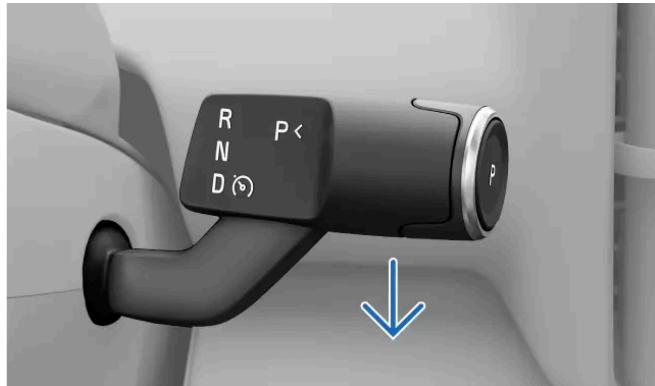
Cuando resulte necesario, mueva la palanca derecha del volante hacia abajo.
