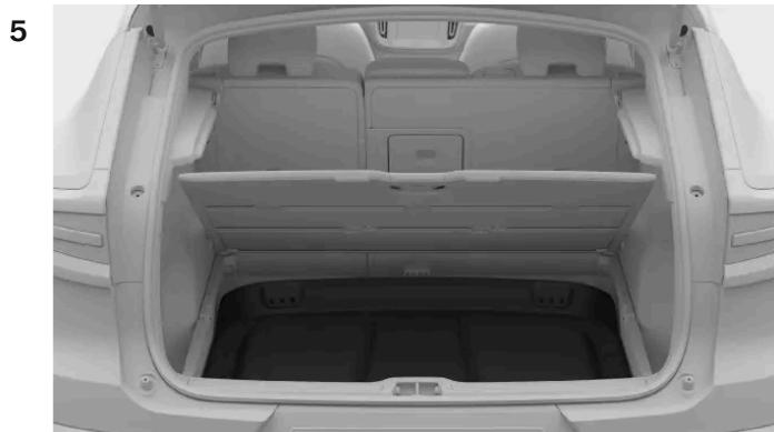
Coloque la bandeja trasera con la parte superior hacia abajo y la parte trasera hacia delante.
