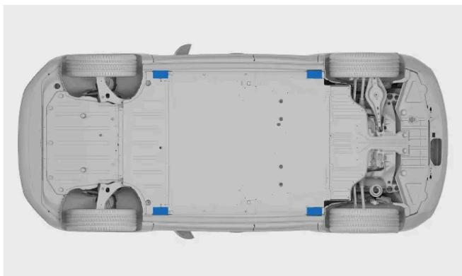
Hay dos puntos de elevación en cada lado del automóvil.
