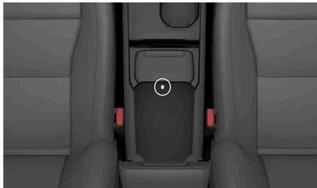
Ubicación del lector de reserva en el interior del compartimento de almacenamiento de la consola del túnel
