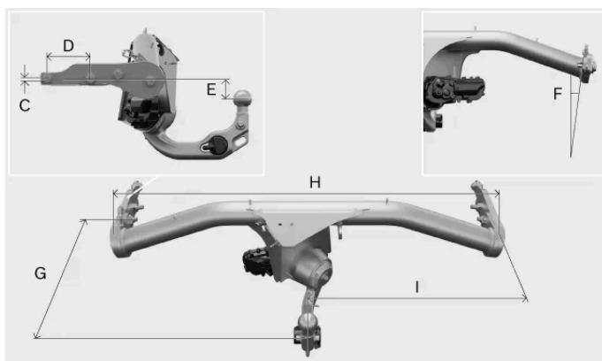
Dimensiones, puntos de fijación en mm (pulgadas)
