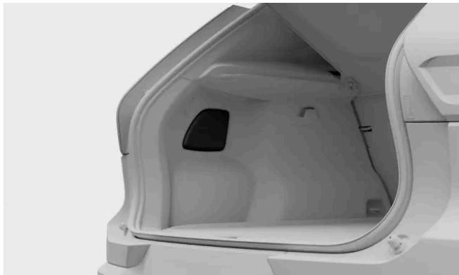
Presione el borde superior de la cubierta del panel para hacerlo pivotar y retirarlo.
