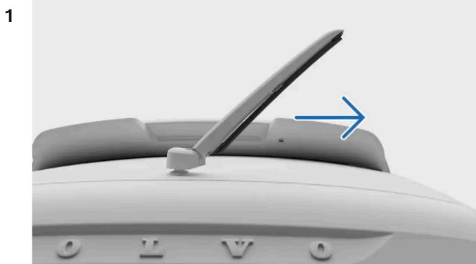
Agarre la parte central del brazo del limpiaparabrisas, élévelo y aléjelo del parabrisas trasero. Puede que detecte un poco de resistencia a medio camino, es la posición de bloqueo. Debe tirar del brazo y pasar de esa posición de bloqueo para que no vuelva a caer encima del parabrisas.
