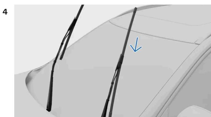
Compruebe que la escobilla del lado del conductor sea más larga que la del lado del acompañante. Deslice la escobilla en el brazo limpiaparbrisas. Asegúrese de que el pasador del brazo del limpiaparbrisas entra en el orificio de la escobilla. Introduzca la escobilla en el brazo del limpiaparbrisas hasta que escuche un clic.
