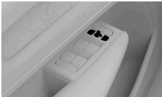
Controles para ajustar los retrovisores exteriores
