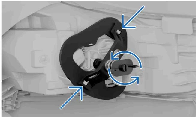
Desenrosque el tornillo de resorte girándolo en sentido contrario a las agujas del reloj. Deje el tornillo en el puente de apoyo para poder recuperarlo cuando lo necesite.
