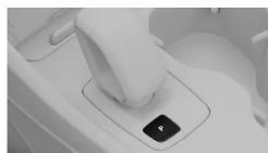
Accione manualmente el freno de estacionamiento pulsando el botón del freno de estacionamiento.
