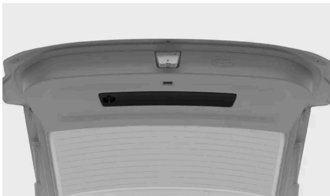
El triángulo de advertencia se encuentra en el interior de la compuerta del maletero. Abra el compartimento girando la manilla hasta que quede en posición vertical y luego tirando de ella.
