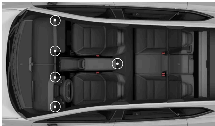
Posiciones de las toberas de ventilación ajustables en el habitáculo.
