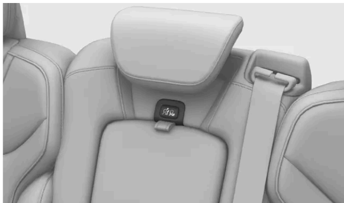
Botón de bloqueo en el reposacabezas central
