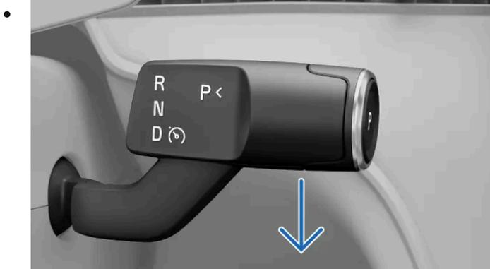
Baje la palanca derecha del volante hasta abajo.
