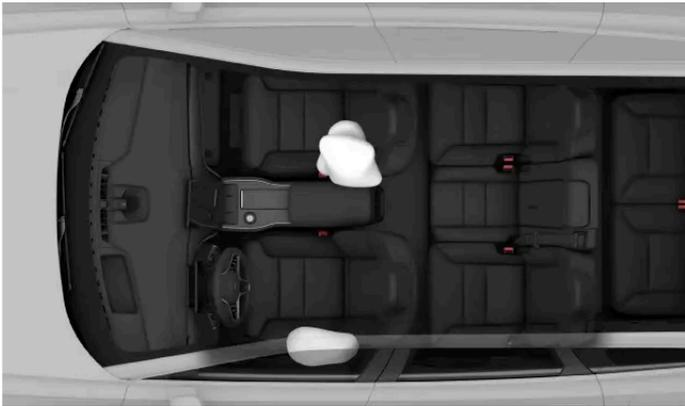
Airbags de colisión lateral izquierda para los ocupantes delanteros. En una colisión por el lado derecho, se despliegan en el lado opuesto de los asientos delanteros, en comparación con lo reflejado en el caso ilustrado.
