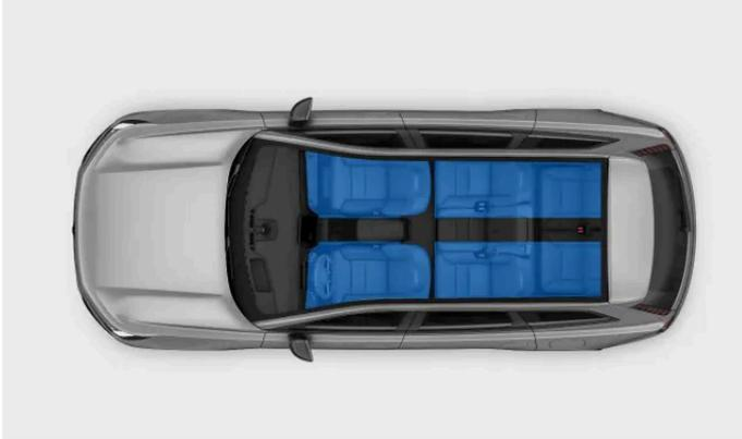
Hay diferentes zonas de climatización en el habitáculo de su automóvil. Todas las zonas están directamente sincronizadas con los ajustes de climatización preferidos de la persona que conduce de forma predeterminada. Sin embargo, las zonas de atrás pueden tener su propio ajuste de temperatura.
