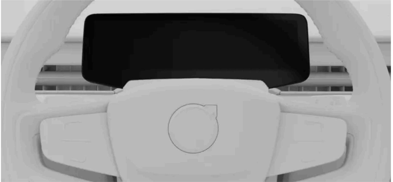
La pantalla del conductor está situada delante del conductor, detrás del volante. Su posición cambia junto con el volante cuando lo ajusta a su postura de conducción deseada.
