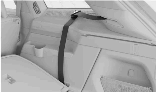
Aparte el cinturón de seguridad de la tercera fila cuando utilice la cubierta de equipajes. Retraiga el cinturón de seguridad y cuéguelo por la hebilla.
