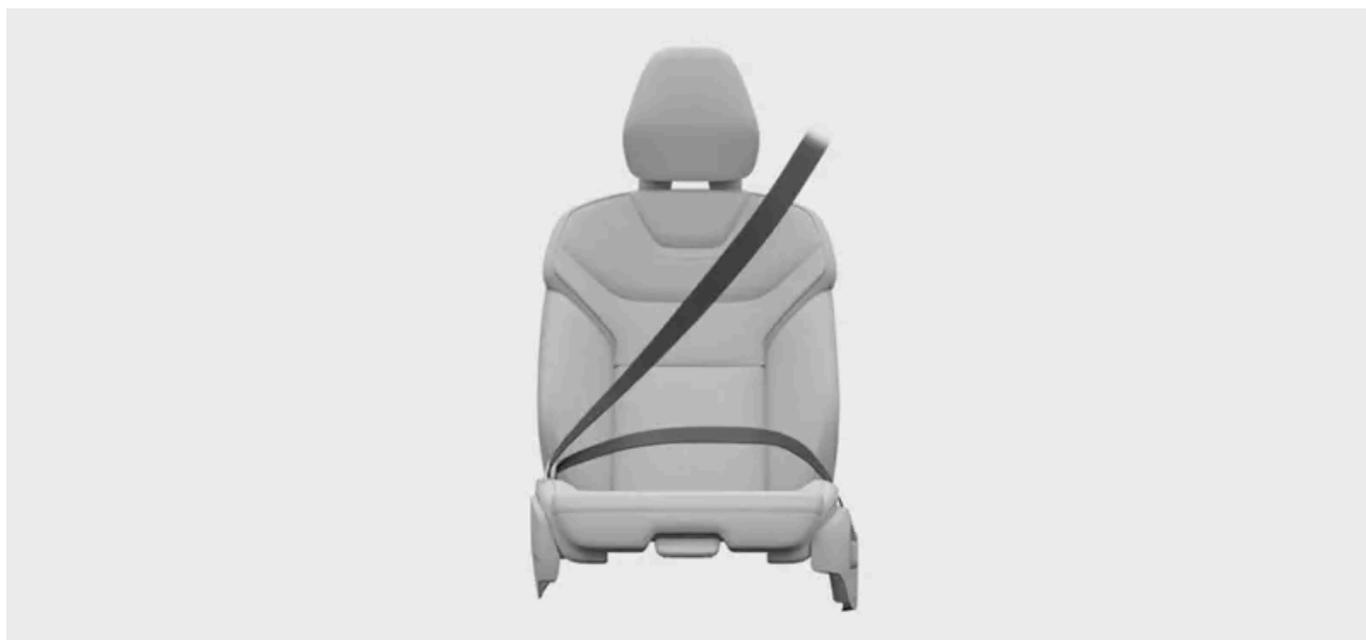
El cinturón se bloquea para actuar como sistema de retención de seguridad en determinadas condiciones, por ejemplo si se tira de forma brusca y forzada del cinturón, en caso de conducción agresiva o si el automóvil está en una pendiente pronunciada.
