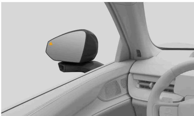
Cuando el automóvil detecta tráfico que se aproxima a sus laterales, aparece una luz en el retrovisor exterior. Si empieza a abrir la puerta en el lado en el que se ha detectado tráfico, la alerta se intensifica. Puede sonar una alerta acústica junto con las alertas visuales, en función de la urgencia de la advertencia.
