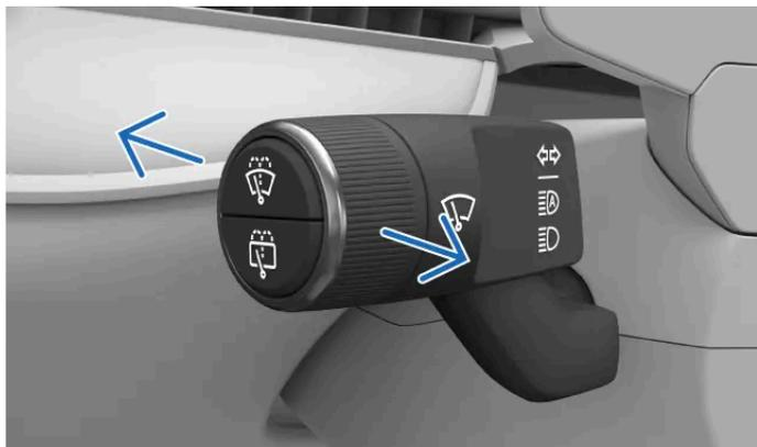
Puede mover la palanca izquierda hacia delante o atrás para cambiar entre diferentes opciones de luces largas. La palanca siempre vuelve a la posición neutra.
