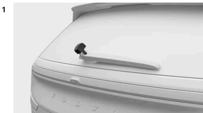
Localice la tapa de plástico en la que el brazo limpiaparabrisas está conectado al automóvil. Afloje primero el lado de la tapa más cercano a su posición y después el más alejado. Levante del todo la tapa de plástico. De este modo podrá acceder al conector de la manguera.
