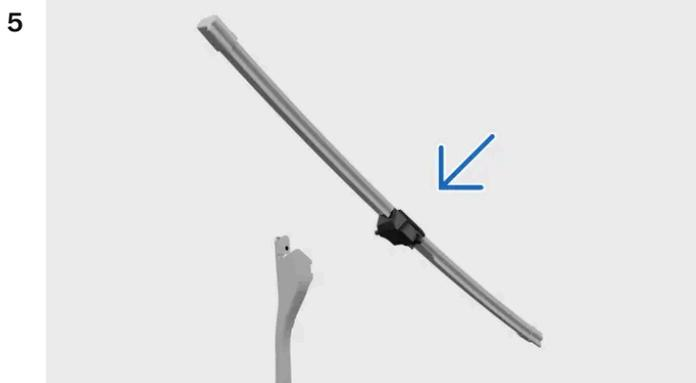
Compruebe que la escobilla del lado del conductor sea más larga que la del lado del acompañante. Sujetando la escobilla en posición horizontal, insértela en el brazo del limpiaparabrisas. Asegúrese de que el pasador del brazo del limpiaparabrisas entra en el orificio de la escobilla.
