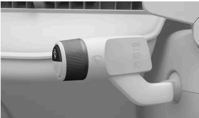
Puede activar diferentes modos del limpiaparabrisas delantero utilizando la palanca izquierda. Los modos son:
