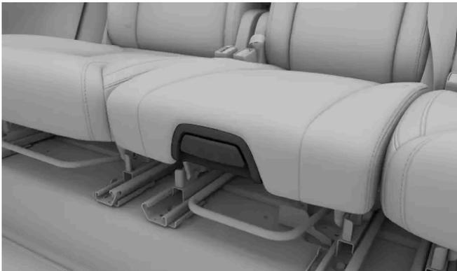
Tire del tirador en la parte delantera del cojín del asiento central para desbloquearlo.
