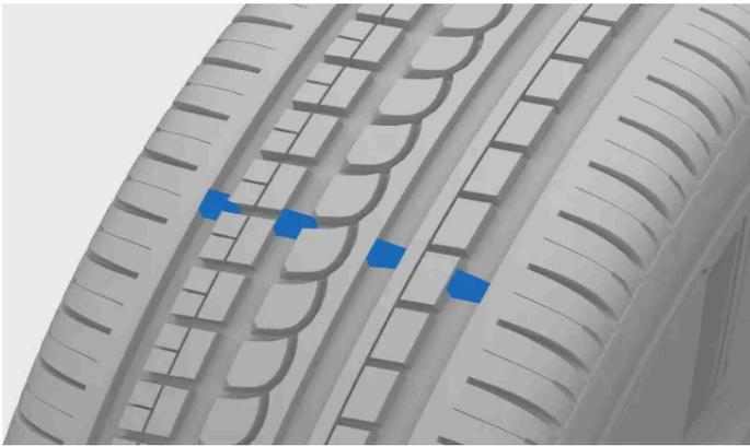
Las ranuras estrechas dispuestas a lo largo de la banda de rodadura del neumático son indicadores de desgaste. En el lateral del neumático figuran las letras TWI [1].
