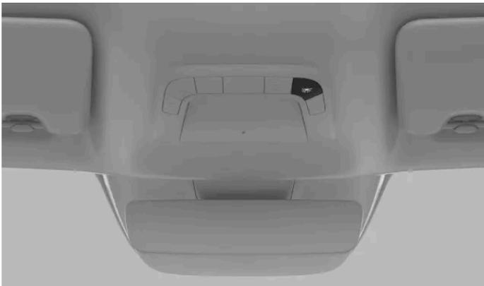
Botón de activación de todas las luces interiores en la consola del techo
