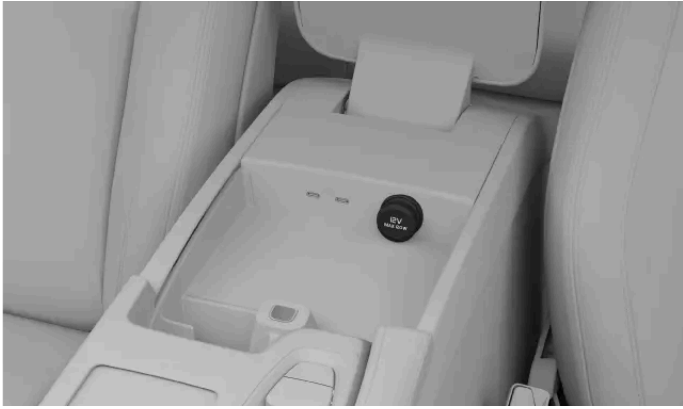
La toma eléctrica de 12 V en la consola del túnel
