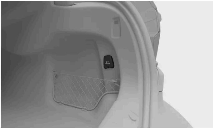
La toma eléctrica de 12 V a la derecha del maletero
