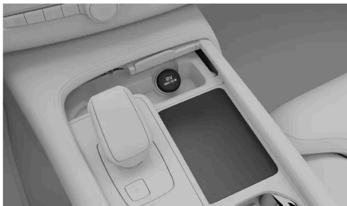
La toma de 12 V en la consola del túnel
