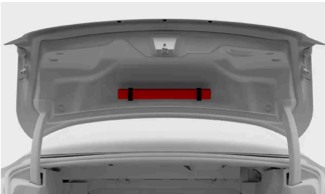
El triángulo de advertencia está fijado con dos abrazaderas en el interior de la compuerta del maletero.
