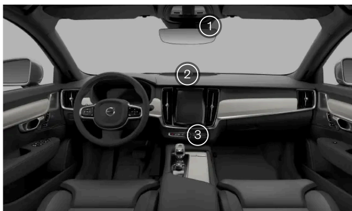
Los sensores de climatización interiores
