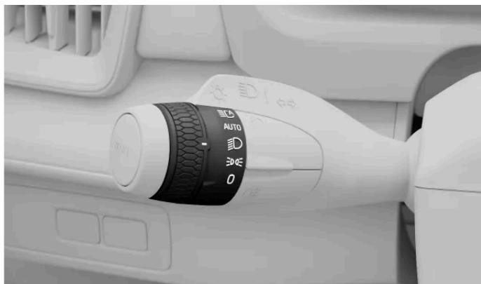
El símbolo de las luces de cruce en el mando giratorio en la palanca izquierda
