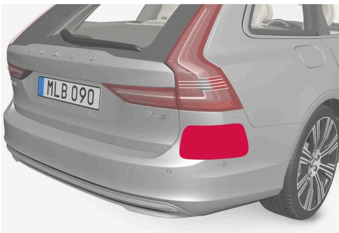
Ubicación de unidades de radar traseras
