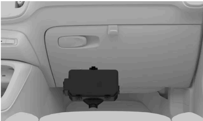
Ubicación de la caja de fusibles
