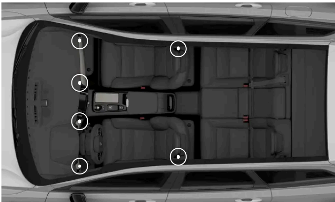
Las posiciones de las toberas de ventilación regulables
