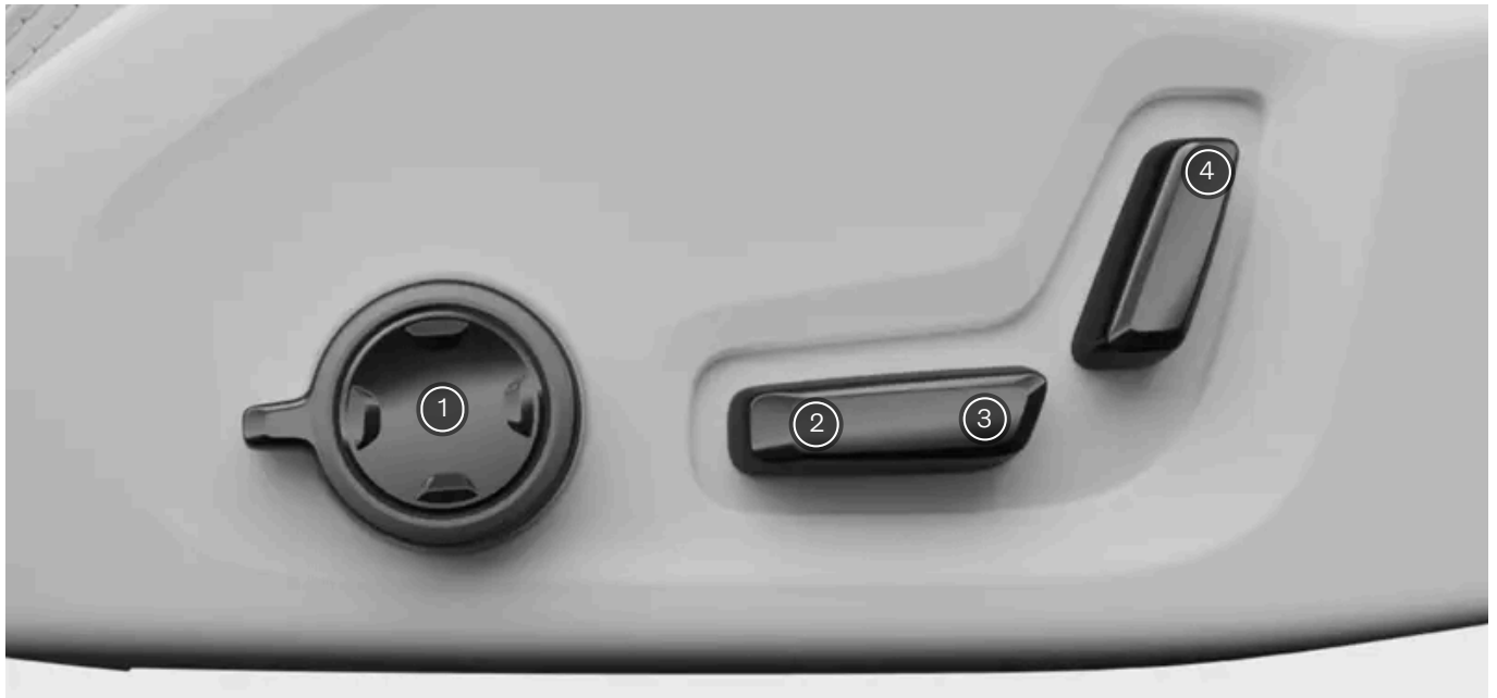
Controles en el lateral del asiento
