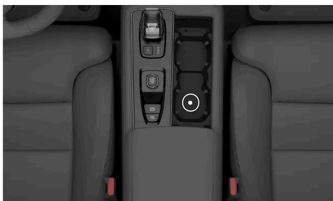
Ubicación del lector de reserva en el interior del portavasos de la consola del túnel
