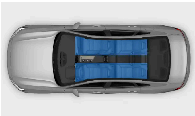
Zonas de climatización
