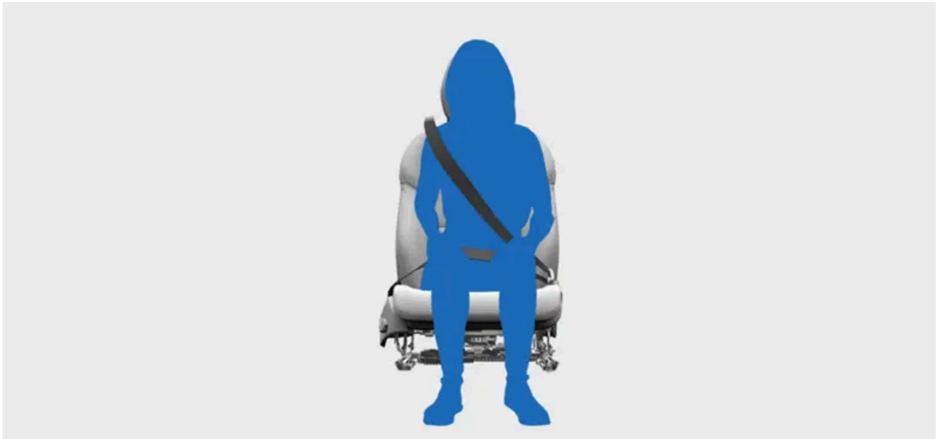
Cinturón de seguridad abrochado y ajustado correctamente.
