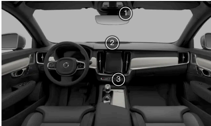
Los sensores de climatización interiores
