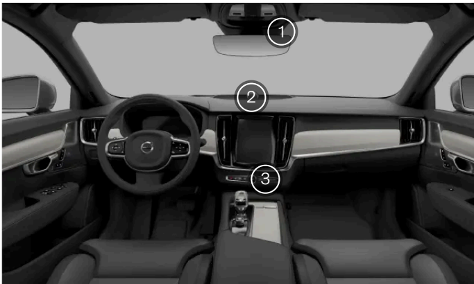
Los sensores de climatización interiores
