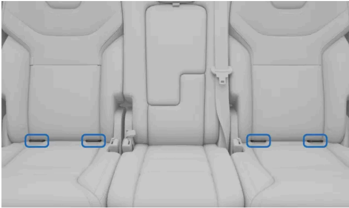
Posición de los puntos de anclaje ISOFIX de los asientos de la segunda fila
