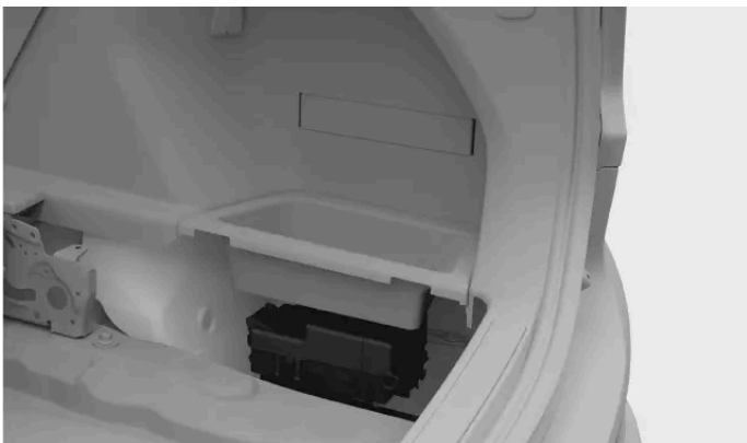
Ubicación de la caja de fusibles
