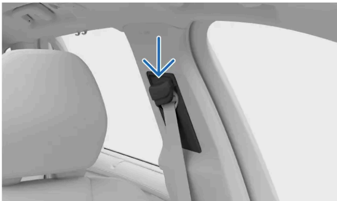
Punto de anclaje superior del cinturón de seguridad
