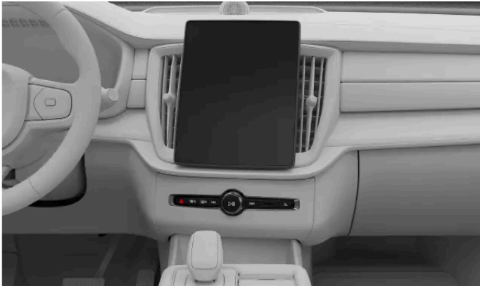
Pantalla central y botones de desempañado en el panel de botones debajo de la pantalla central
