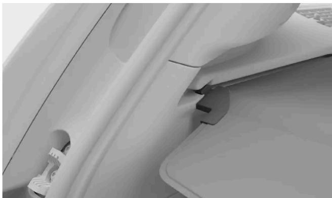
Guíe los extremos de la cubierta de equipajes hasta la posición de bloqueo en las ranuras.
