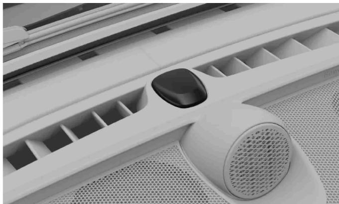
El indicador de alarma es una luz situada en el centro del salpicadero, justo delante del parabrisas. El indicador confirma cuando la alarma está activada con un destello de luz roja.
