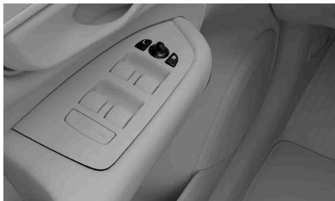
Controles para ajustar los retrovisores exteriores
