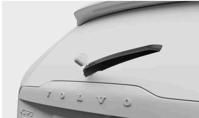
Agarre la parte central del brazo del limpiaparabrisas, élévelo y aléjelo del parabrisas trasero. Puede que detecte un poco de resistencia a medio camino, es la posición de bloqueo. Debe tirar del brazo y pasar de esa posición de bloqueo para que no vuelva a caer encima del parabrisas.
