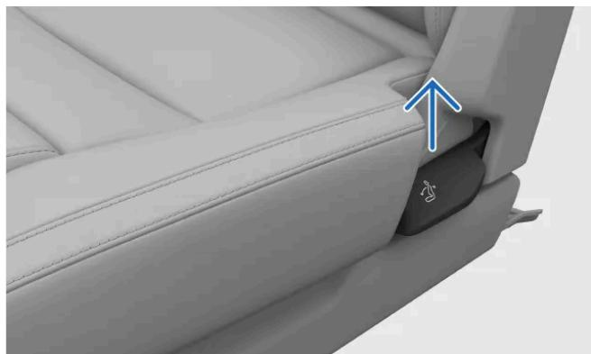
Tire del tirador situado en un lado del asiento hacia arriba para desbloquear el respaldo.
