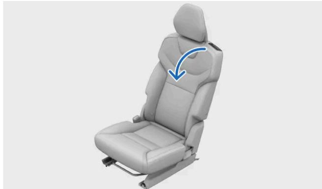
Tire del tirador situado en la parte superior del respaldo del asiento exterior.
