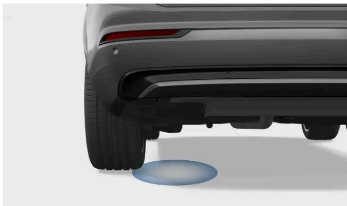
El sensor detecta el movimiento debajo del parachoques trasero. Cualquier movimiento detectado desbloquea el maletero.
