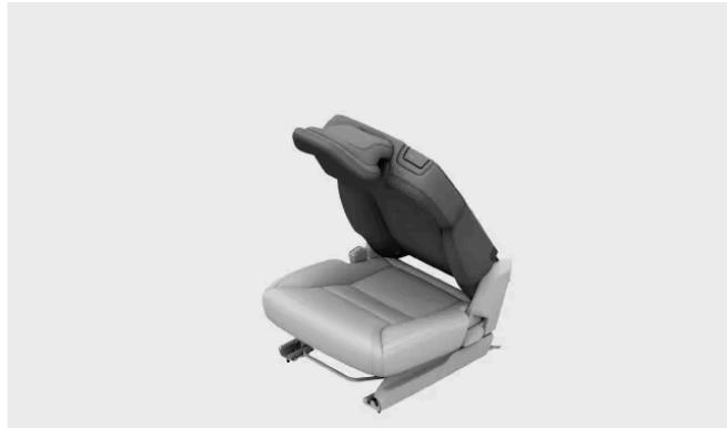
Tire del respaldo para que se incline hacia delante hasta detenerse.
