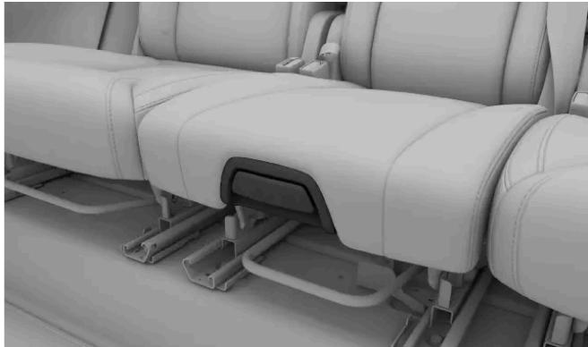
Tire del tirador de la parte delantera del cojín del asiento para desbloquearlo.
