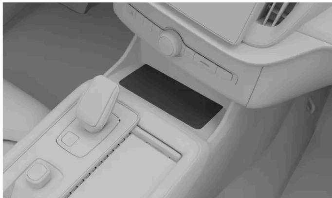
Para usar el cargador inalámbrico, su dispositivo debe tener la certificación de cumplimiento de la norma de carga inalámbrica Qi. Compruebe también que la carga inalámbrica esté activada tanto en el dispositivo <sup>[1]</sup> como en el cargador. Puede activar el cargador en la pantalla central.
