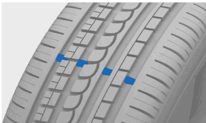
Las ranuras estrechas dispuestas a lo largo de la banda de rodadura del neumático son indicadores de desgaste. En el lateral del neumático figuran las letras TWI<sup>[1]</sup>.
