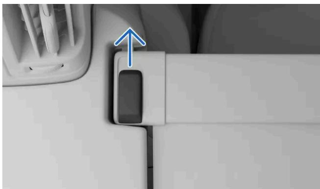
En los extremos de la cubierta de equipajes hay botones de bloqueo. Mueva el botón de un lateral hacia delante y manténgalo en esa posición mientras levanta el extremo de la cubierta. Haga lo mismo con el otro extremo.
