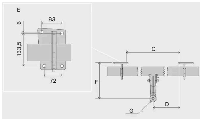
Dimensiones, puntos de fijación en mm (pulgadas)
