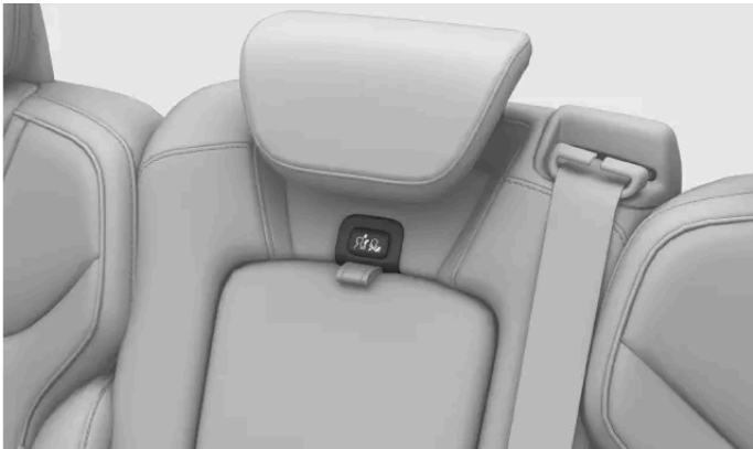
Botón de bloqueo en el reposacabezas central
