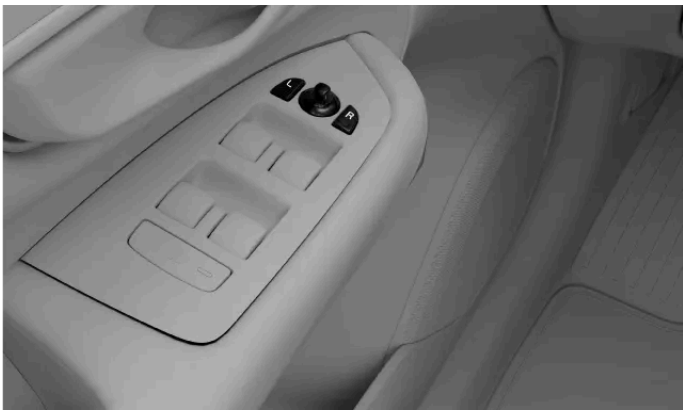
Controles para ajustar los retrovisores exteriores
