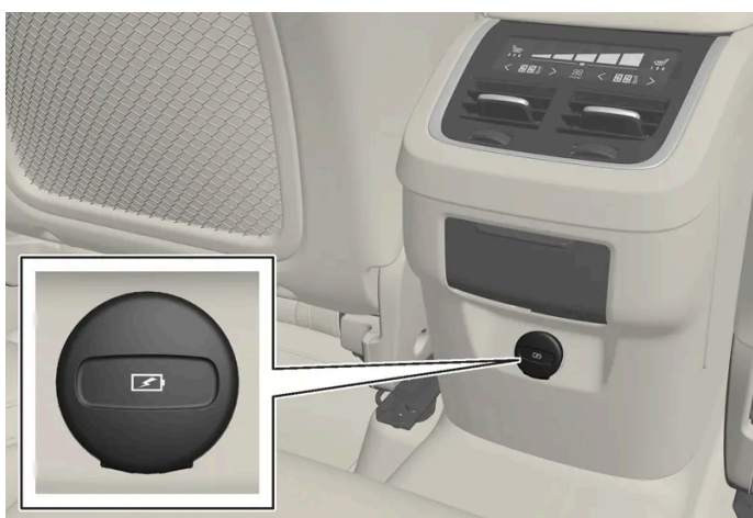
Puertos USB (tipo C) en la parte trasera de la consola del túnel para cargar, por ejemplo, teléfonos y tabletas [1] .
