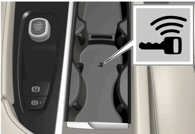
Ubicación del lector de seguridad en la consola del túnel.
