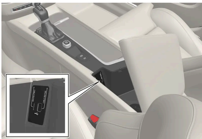
Puertos USB (tipo A) en la consola del túnel. Coloque el cable hacia delante para evitar que quede aprisionado al cerrar la tapa.
