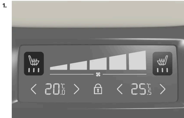
Indicación de calefacción del asiento y mandos en el panel de climatización de la consola del túnel.
