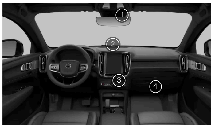
Capteurs intérieurs de climatisation
