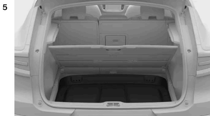
Placez la plage arrière en orientant sa partie supérieure vers le bas et sa partie arrière vers l'avant.
