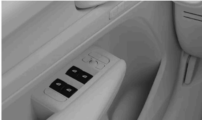
Utilisez les interrupteurs pour ouvrir ou fermer les vitres :
