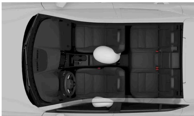
Coussins gonflables pour collisions par la gauche pour les occupants avant Dans une collision par la droite, ils se déplient de l'autre côté de chacun des sièges avant, de manière symétrique à la situation illustrée.
