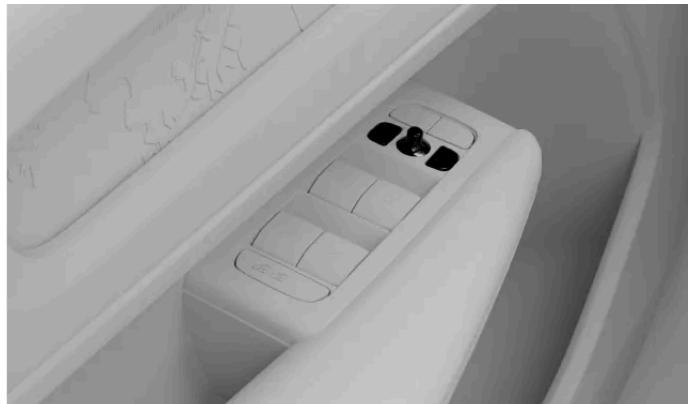
Commandes de réglage des rétroviseurs extérieurs
