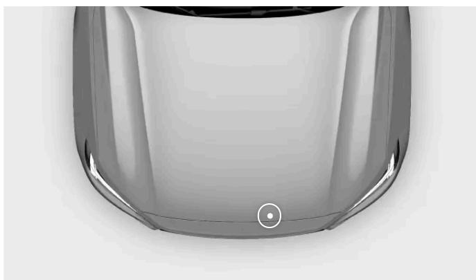
Le second levier se trouve en dessous du bord avant du capot, du côté conducteur.
