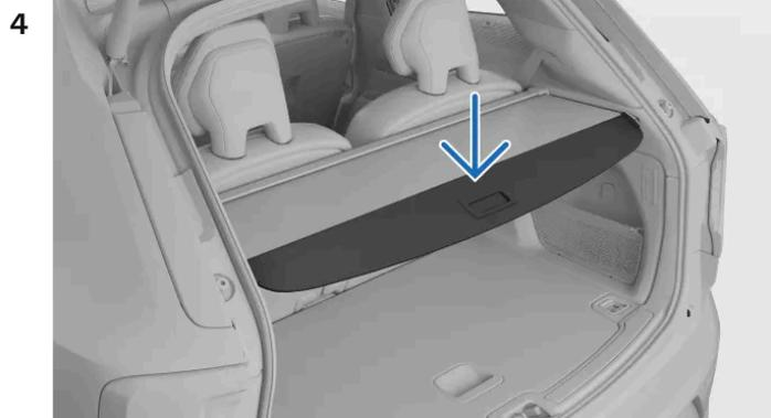
Inclinez le bord extérieur du cache-bagages vers le bas de sorte qu'il se verrouille dans les rainures.
