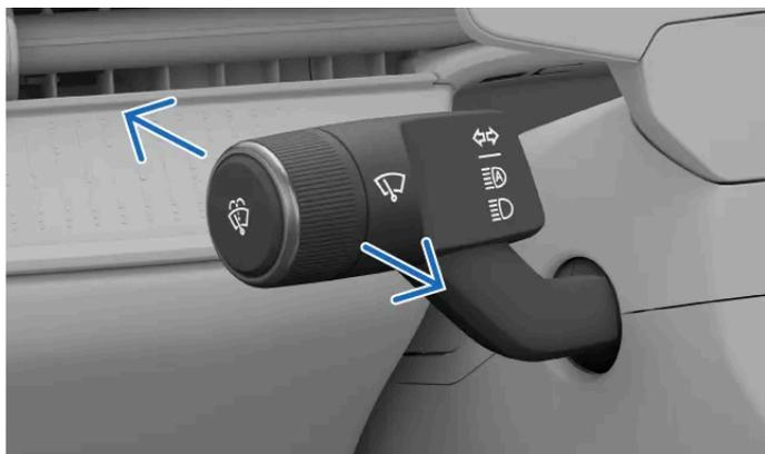
Vous pouvez déplacer le levier de commande au volant gauche vers l'avant ou vers l'arrière pour alterner différentes options de feux de route. Le levier revient toujours à la position neutre.
