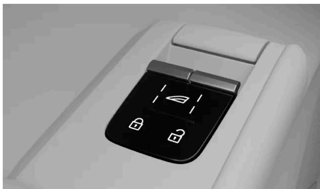
Appuyez sur le symbole de vitre
