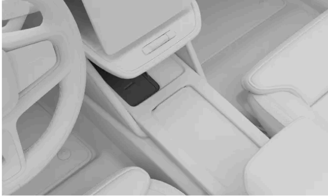
Position du lecteur de cartes-clés utilisé pour démarrer la voiture avec une carte-clé ou avec une clé à fonction de commande à distance déchargée
