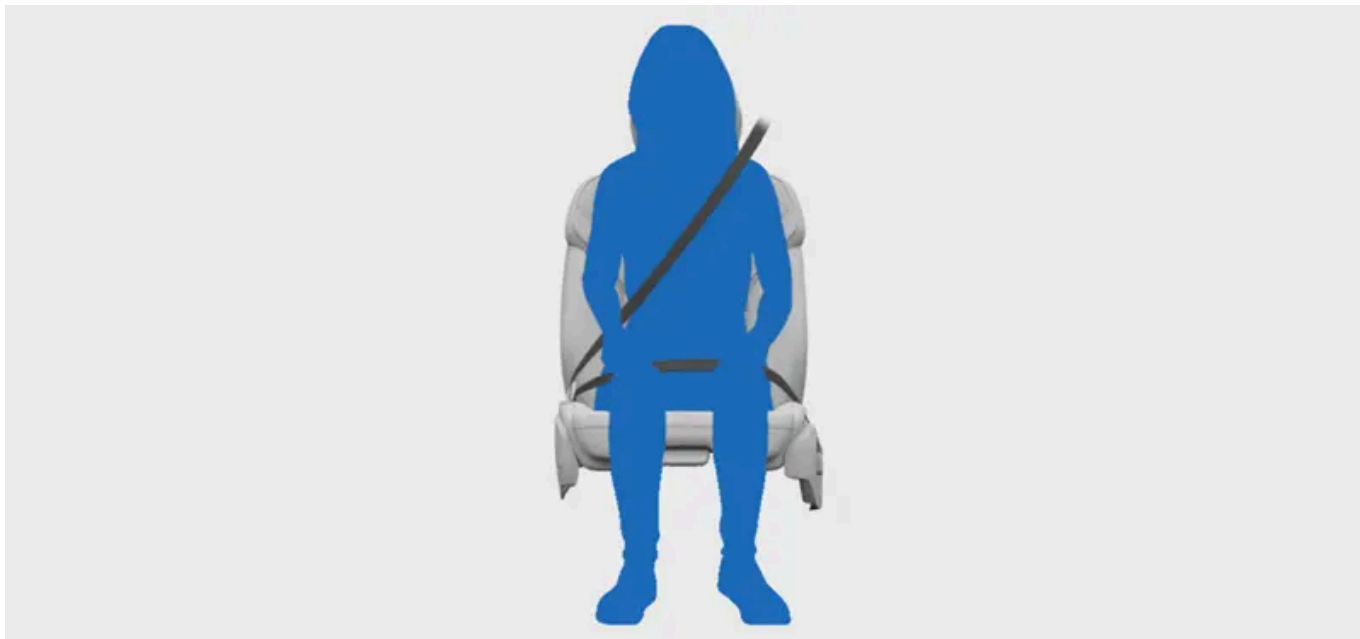
Ceinture de sécurité correctement bouclée et ajustée
