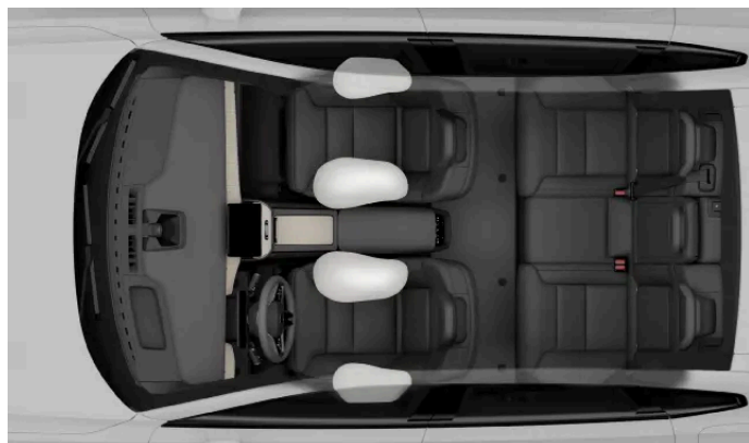
Ensemble des coussins gonflables des sièges avant pour les collisions latérales.
