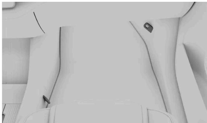
Avec l'accessoire de sangle inférieure avant<sup>[1]</sup>, des points de fixation sont également situés sur les côtés de la cave à pieds du siège passager avant.
