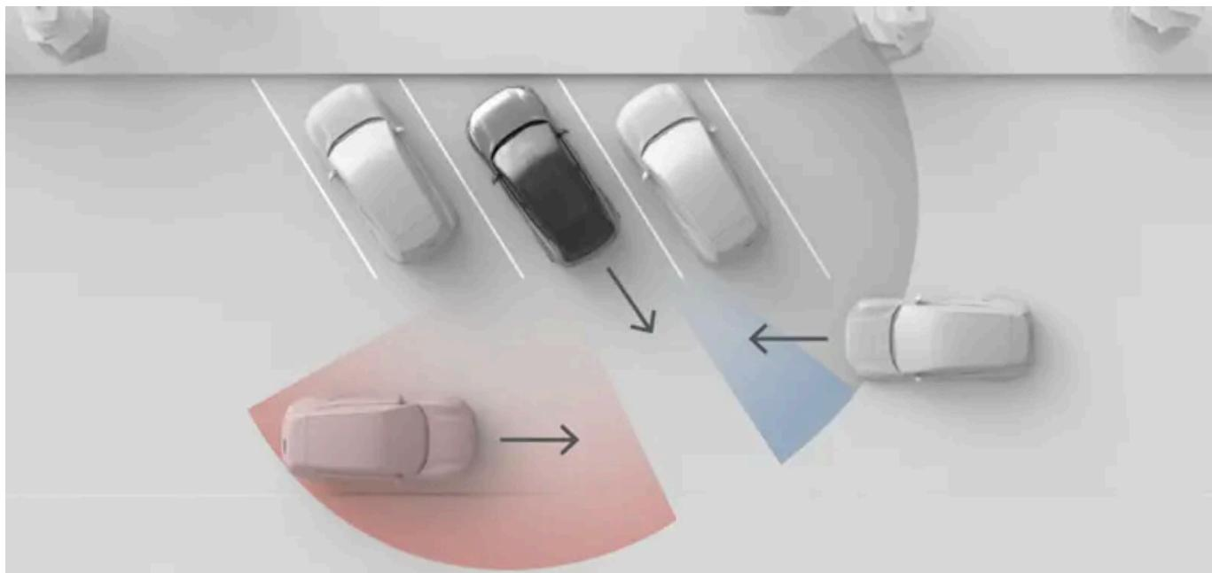
La situation illustrée montre de quelle façon des objets environnants, par exemple des voitures en stationnement, peuvent limiter le champ de détection du radar. En l'absence d'obstacle, les zones de détection effectives sont identiques des deux côtés.
