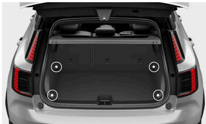
Des œillets d'arrimage de charge sont situés aux quatre coins du coffre. Vous pouvez utiliser les œillets d'arrimage de charge pour attacher des sangles et sécuriser la cargaison dans le coffre.
