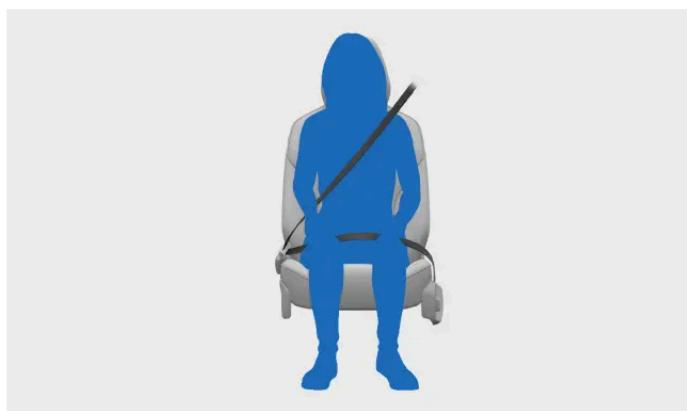
La ceinture de sécurité se bloque pour jouer le rôle de dispositif de retenue de sécurité dans certaines conditions, par exemple lorsque la ceinture subit une traction soudaine et forte, lorsque la voiture est conduite agressivement ou lorsque la voiture se trouve dans une forte pente.
