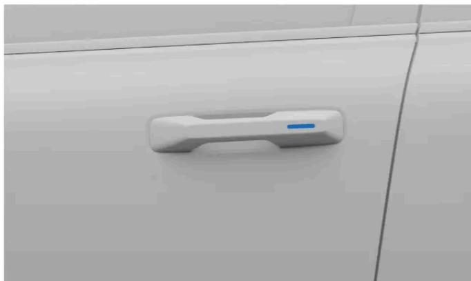
Le renforcement marque l'endroit où vous pouvez placer le pouce ou les doigts pour verrouiller la porte.
