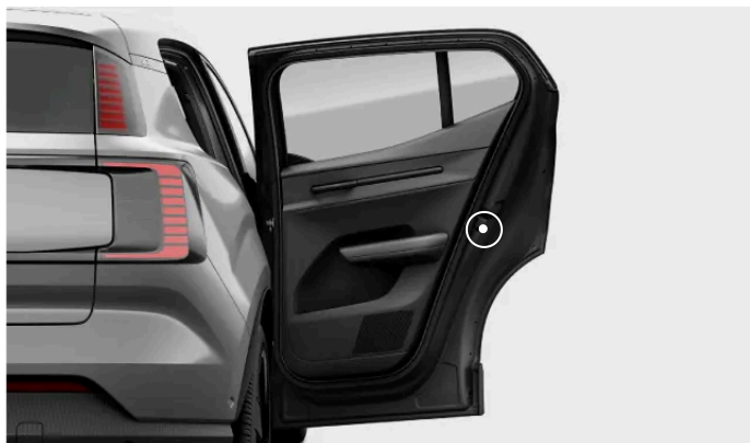
Emplacement des interrupteurs de sécurité enfant.
