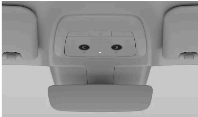
Liseuses des sièges avant dans la console au plafond
