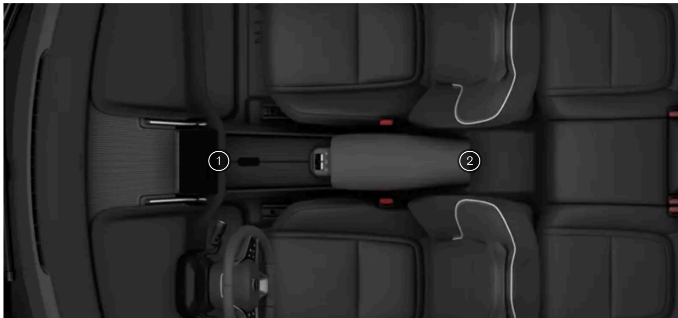
Position des ports USB
