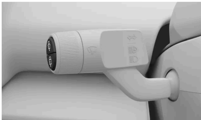
Boutons de lave-glace sur le levier de commande au volant gauche.
