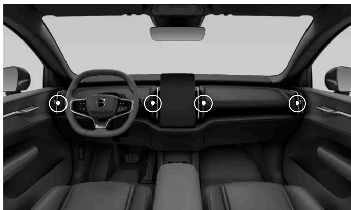
Position des buses de ventilation réglables
