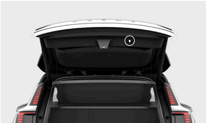
Position du bouton de fermeture du coffre
