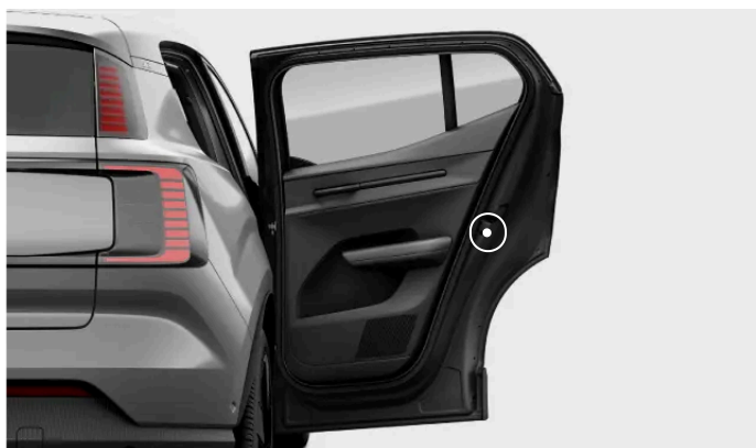
Emplacement des interrupteurs de sécurité enfant.
