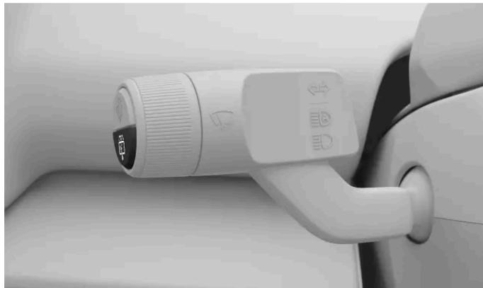
Vous contrôlez l'essuie-glace de lunette arrière en utilisant le bouton inférieur du levier de commande au volant gauche.
