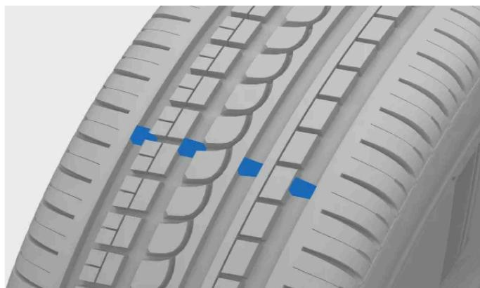
Les talons étroits placés en travers des sculptures du pneumatique sont des témoins d'usure. Sur le côté du pneumatique figure la mention TWI [1].
