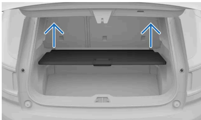
Instructions illustrées de retrait de la trappe de soute
