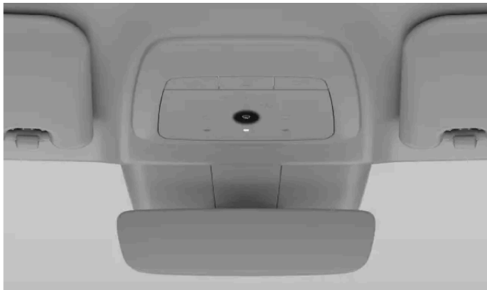
Bouton de dégivrage sur la console au plafond
