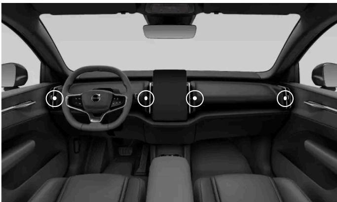
Position des buses de ventilation réglables
