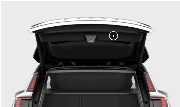
Position du bouton de fermeture du coffre
