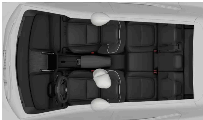
Coussins gonflables latéraux pour les occupants avant
