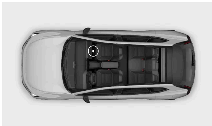
Position du VIN sur la traverse sous le siège passager
