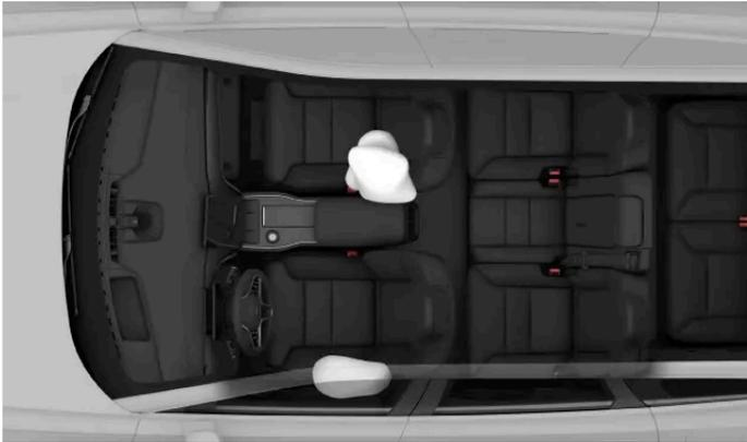
Coussins gonflables pour collisions par la gauche pour les occupants avant. Dans une collision par la droite, ils se déploient de l'autre côté de chacun des sièges avant, de manière symétrique à la situation illustrée.
