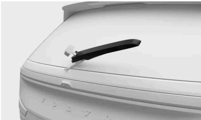
Agrippez le centre du bras d'essuie-glace et soulevez-le de la lunette arrière. Vous ressentirez peut-être une légère résistance à mi-chemin : il s'agit de la position de verrouillage. Le bras d'essuie-glace doit passer cette position de verrouillage pour ne pas se remettre en position sur la lunette arrière.
