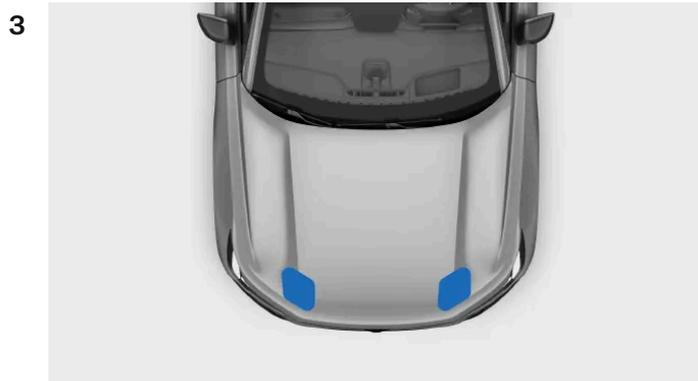
Endroit où appuyer sur le capot pour le fermer
