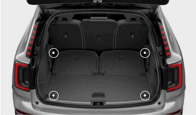
Des œillets d'arrimage de charge sont situés aux quatre coins du coffre. Vous pouvez utiliser les œillets d'arrimage de charge pour attacher des sangles et sécuriser la cargaison dans le coffre.
