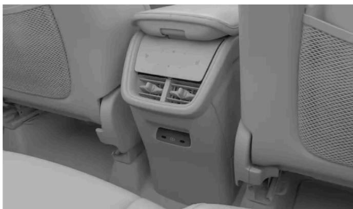
Deux autres ports USB<sup>[1]</sup> se trouvent à l'arrière de la console de tunnel.
