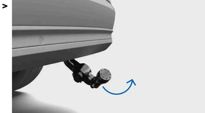
Le crochet d'attelage est déployé. Pendant que le crochet d'attelage se déploie, le symbole du bouton de déploiement clignote.
