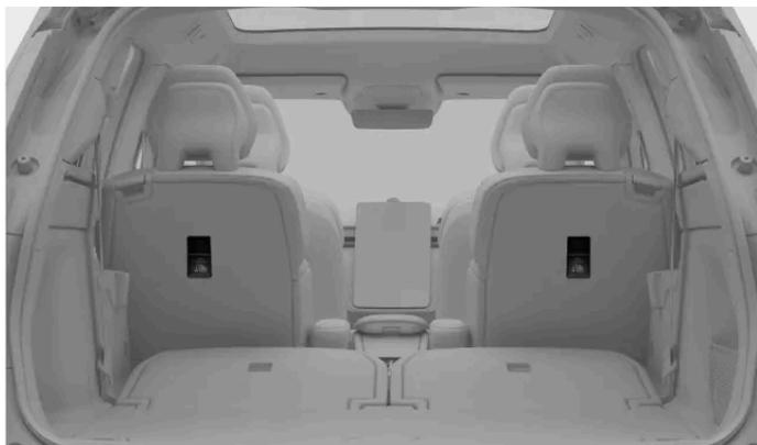
La position des points de fixation de sangle supérieure pour les sièges arrière est indiquée par le symbole de sangle supérieure.
