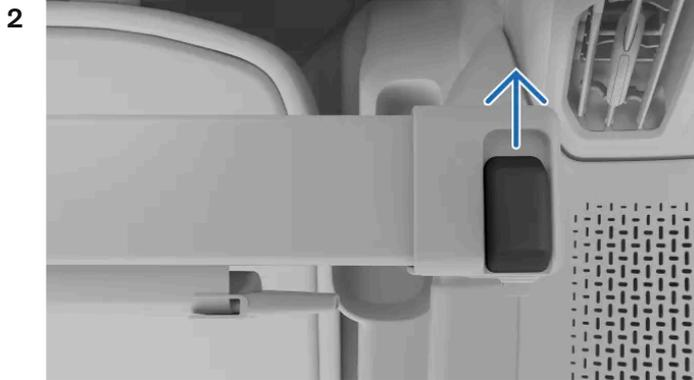
Les extrémités du cache-bagages comportent des boutons de verrouillage. Poussez vers l'avant le bouton de l'un des côtés et tenez-le tout en soulevant l'extrémité du cache-bagages. Procédez de la même façon pour l'autre extrémité du cache-bagages.
