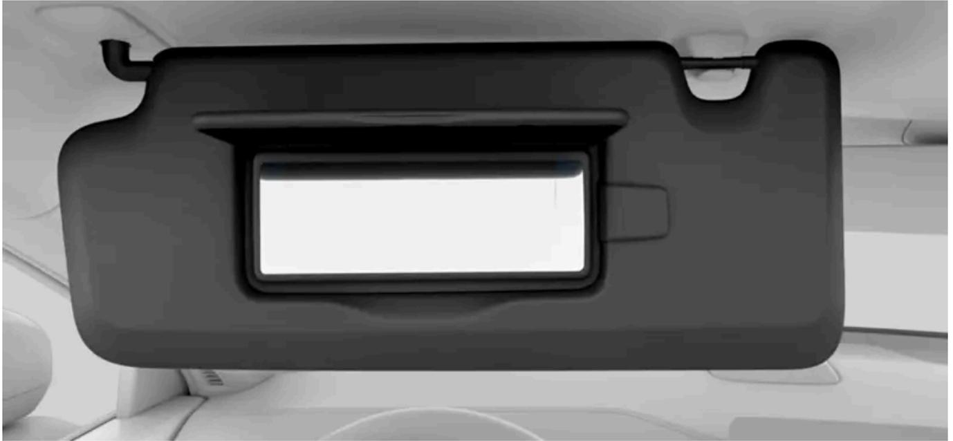
Les pare-soleils peuvent être abaissés et pivotés sur le côté si nécessaire. Vous pouvez également allonger la tige maintenant le pare-soleil pour corriger sa position lorsqu'il est placé sur le côté.
