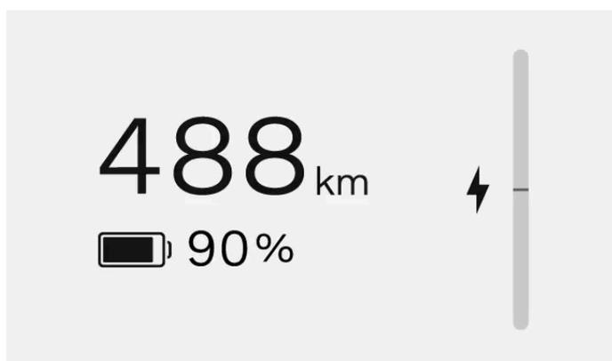
Votre autonomie est principalement liée au niveau de la batterie de votre voiture et à votre conduite, mais des facteurs extérieurs peuvent également intervenir. Le niveau de la batterie et l'autonomie prévue sont affichés à l'écran conducteur. L'autonomie prévue est calculée en fonction de la façon dont vous conduisez actuellement et dont vous avez conduit par le passé.
