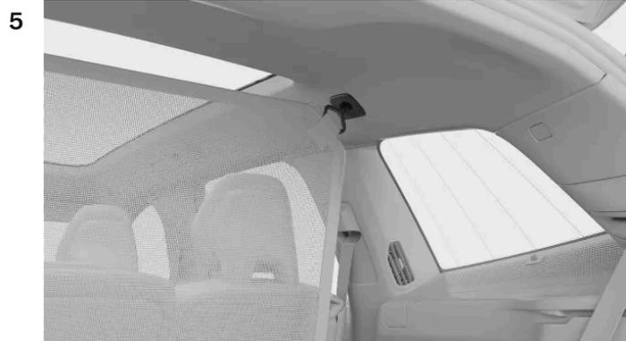
Insérez chaque goupille du filet de protection dans les logements sur les côtés du plafond. Poussez les goupilles vers l'avant jusqu'à ce qu'elles se verrouillent.
