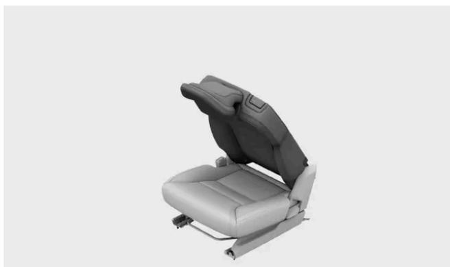
Tirez sur le dossier pour l'incliner vers l'avant jusqu'à la butée.
