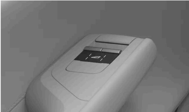
Appuyez sur le symbole de vitre
