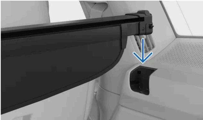
Poussez le cache-bagages dans les logements des deux côtés jusqu'à ce qu'il se mette en place. Vérifiez que les verrouillages sont dans une position telle que les repères rouges sont recouverts.
