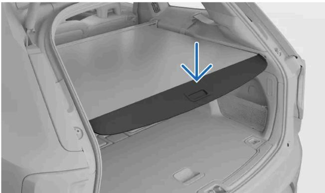
Inclinez le bord extérieur du cache-bagages vers le bas de sorte qu'il se place dans les rainures.
