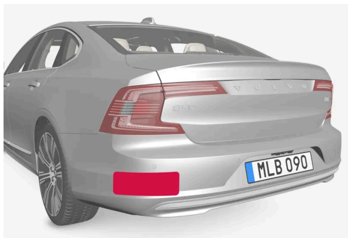
Position des unités radar arrière
