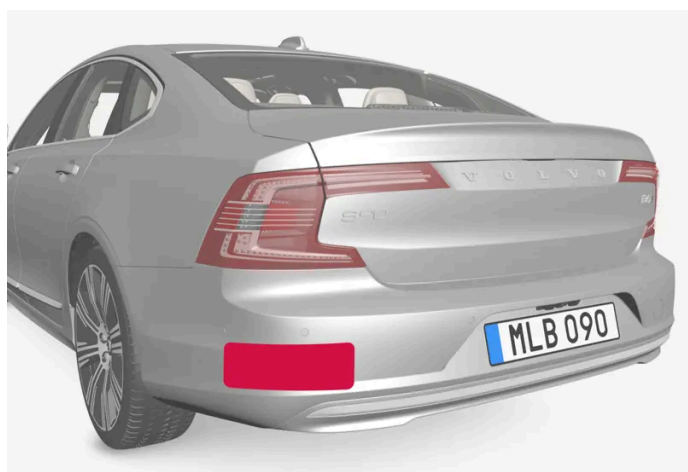
Position des unités radar arrière
