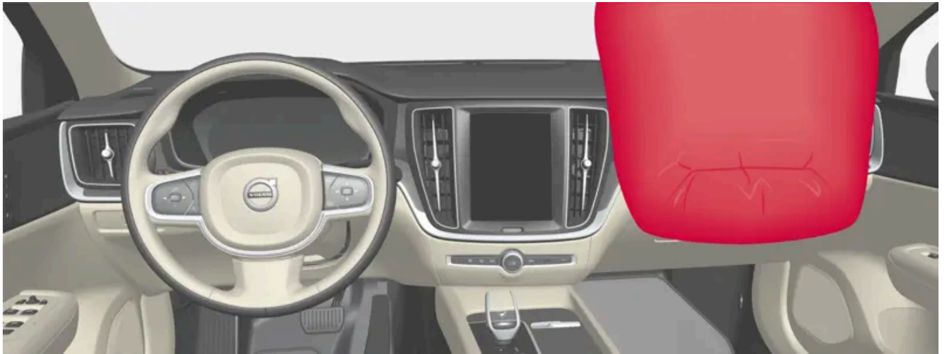
Coussin gonflable côté passager, siège avant.
