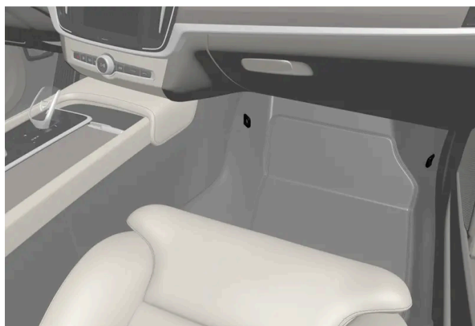
Emplacement des points de fixation sur le siège avant.
